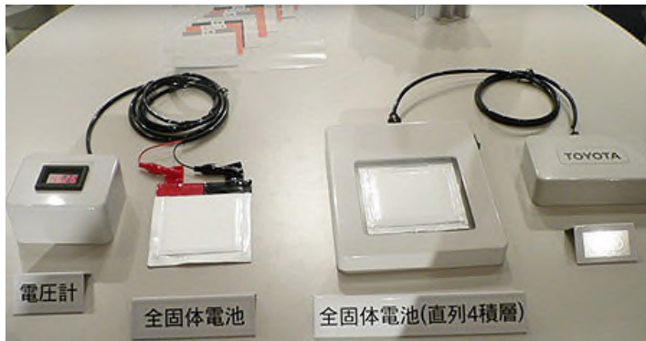
图 11. 丰田开发的新型固态电解质材料 \text{Li}_{10}\text{GeP}_2\text{S}_{12} 和全固态锂离子电池 (上图引自日本技术在线) (真锂研究, 2012 年 09 月 28 日)
